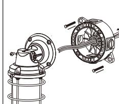
Étape 4: Connecter les câbles du circuit aux câbles du luminaire à l'aide de cosses et d'un ruban isolant afin d'obtenir un raccordement plus sûr.
